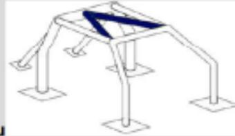
Pour les compétitions sans copilote, dans le cas du dessin avec la croix uniquement, une seule entretoise diagonale peut être montée mais sa connexion avant doit être du côté du pilote.
